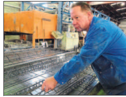
Betonbauer Carten Pätzold richtet in der Produktion Metallträger aus.
